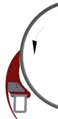
Einbau REMACLEAN PUR-F300
