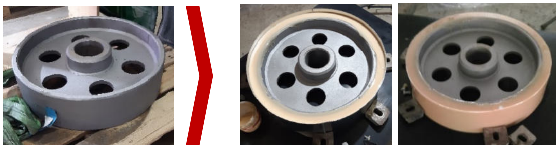
Lauf rad beschichtung mit REMAPUR (Polyurea)
