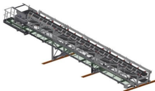
Umbau Antrieb und Spannstation im Tagebau
