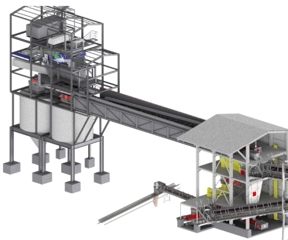
Erstausrüstung und Erweiterung von Förderstrecken
