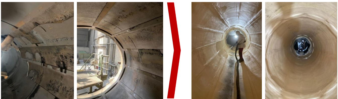
Neuauskleidung von Mischtrommeln mit REMAPUR 75
