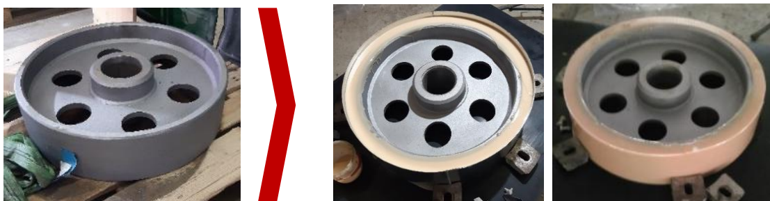
Laufradbeschichtung mit REMAPUR (Polyurea)
