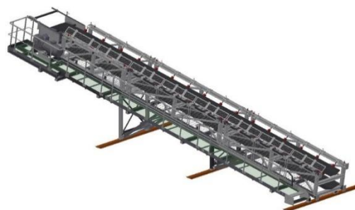
Umbau Antrieb und Spannstation im Tagebau
