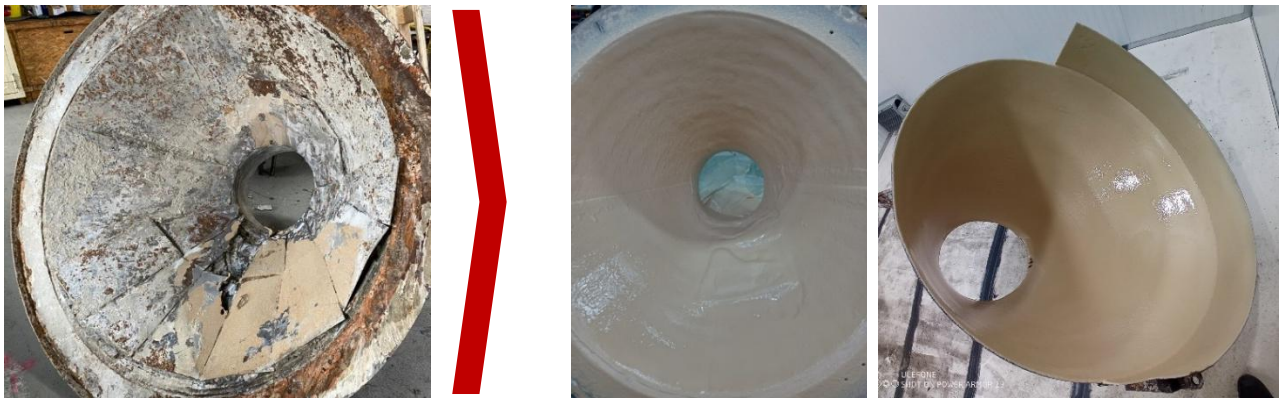
Sprühbeschichtung von Trichter
